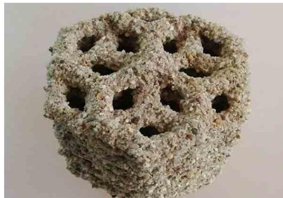
3D-Druck mit Biobeton
